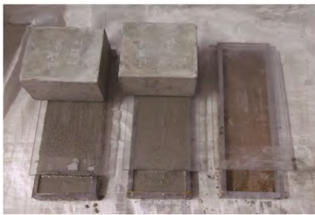
图 1 砂浆静态稳定性测试装置
